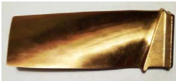
Рис. 2. Внешний вид лопатки компрессора с защитным противозерозионным покрытием
