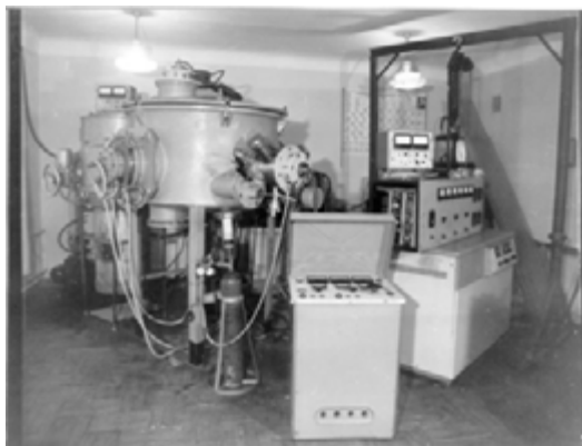
Рис. 2. Установка корпускулярного легирования и ее схема
