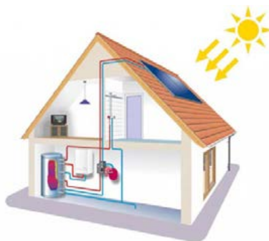
Рис. 2. Принцип работы системы солнечного отопления дома
