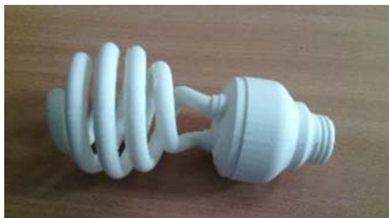
Рис. 1. Модель лампы, распечатанной на 3D – принтере
