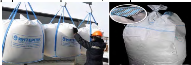
Рис. 3. Мягкий полимерный контейнер типа «Биг-Бег»
