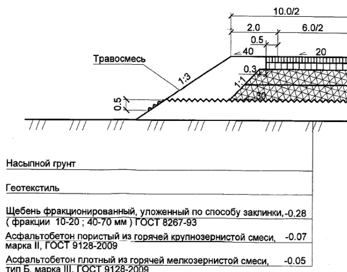
Рис. 2. Кострукция дорожной одежды с использованием геотекстиля.
