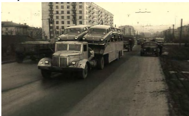
Рис. 4. Автопоезд А-820 (перевозка девяти автомобилей «Москвич»)
