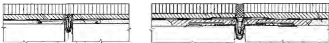
Рис.1. Конструкции деформационных швов закрытого и заполненного типов.
