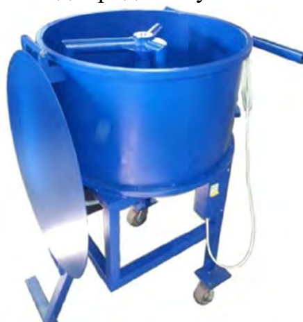
Рис.7 Смеситель принудительного действия
