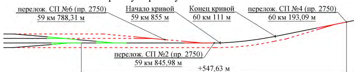
Рис. 4. Схема продления прямо-отправочных путей по варианту 2
