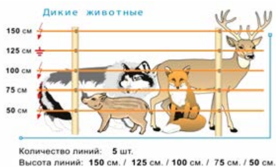
Рис. 3. Устройство электрического забора вдоль проезжей части.
