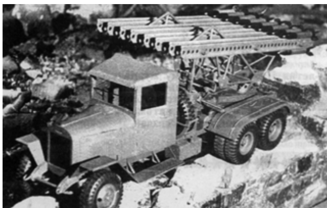
Рис. 3. Легендарная «катюша» БМ-13 на шасси ЗИС-6.
