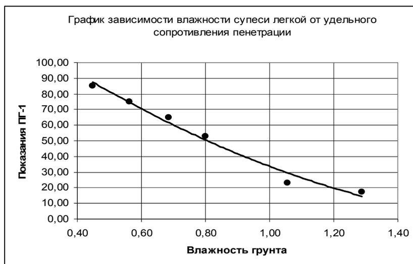
Рис. 1. Зависимость показаний плотнмера ПГ-1 от относительной влажности грунта-супеси легкой
