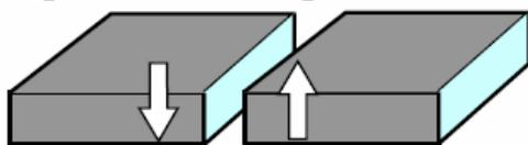
например, при реконструкции бетонного покрытия, применяется для локальной стабилизации бетонных плит
