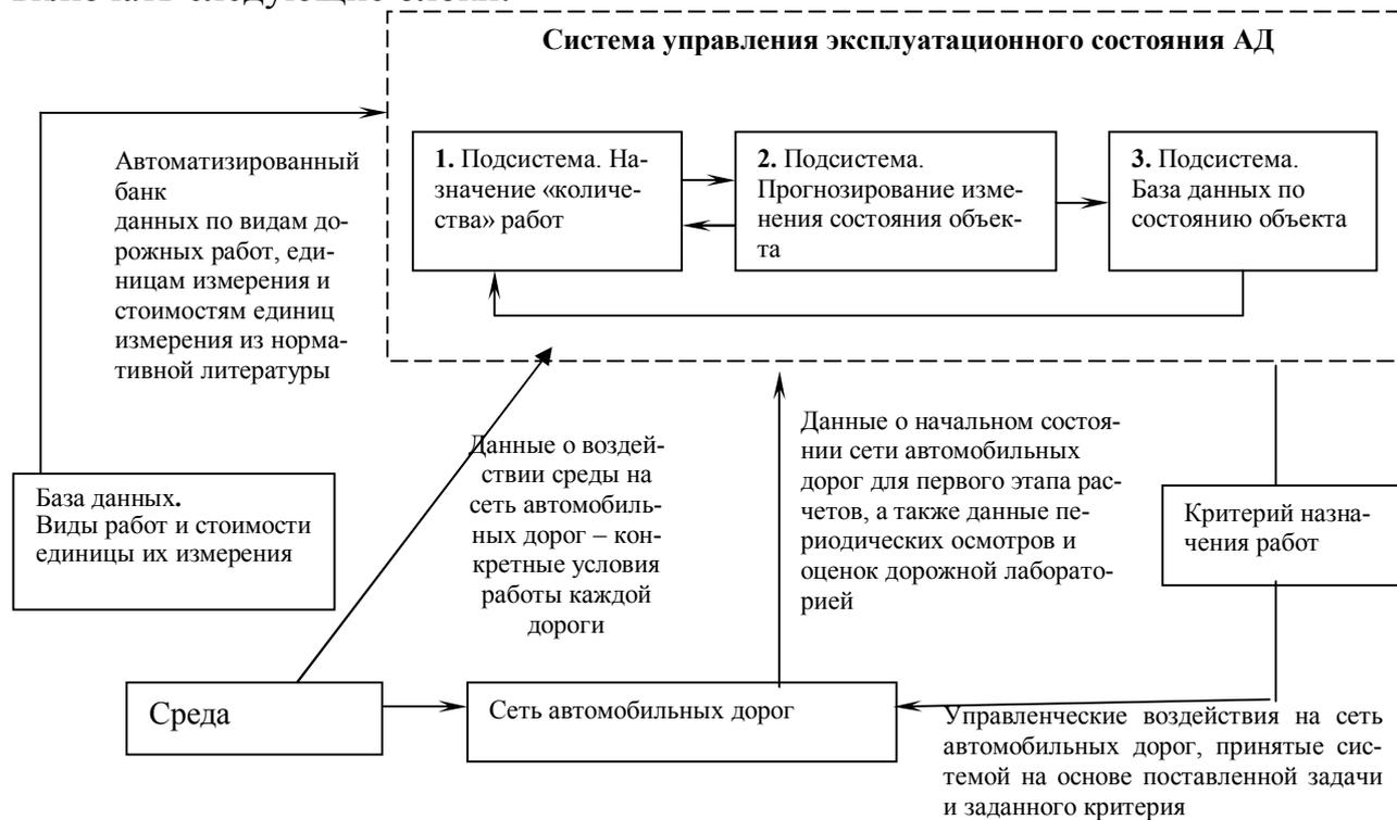
Рис. 1. Предлагаемая система поддержки принятия решений в области управления эксплуатационным состоянием АД
