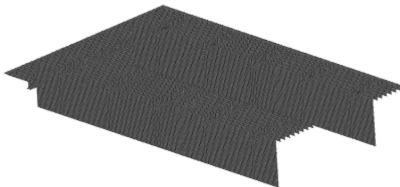
Рис.3 Расчетная схема участка пролетного строения с полосовыми продольными ребрами.
