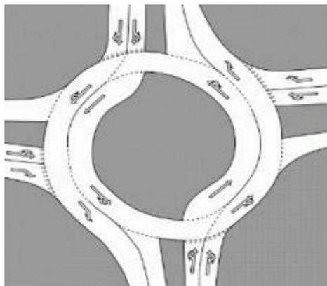
Рис. 4. Схема движения по турбо-кольцу
