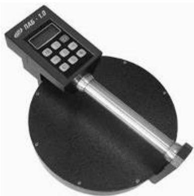
Рис.3 Прибор для определения плотности асфальтобетона
