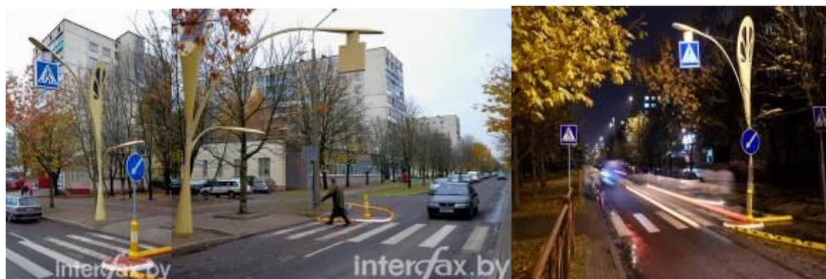
Рис. 5 Сужение проезжей части на нерегулируемом пешеходном переходе, выполненное с помощью светоотражающих элементов (г. Минск, ул. Сердича)
