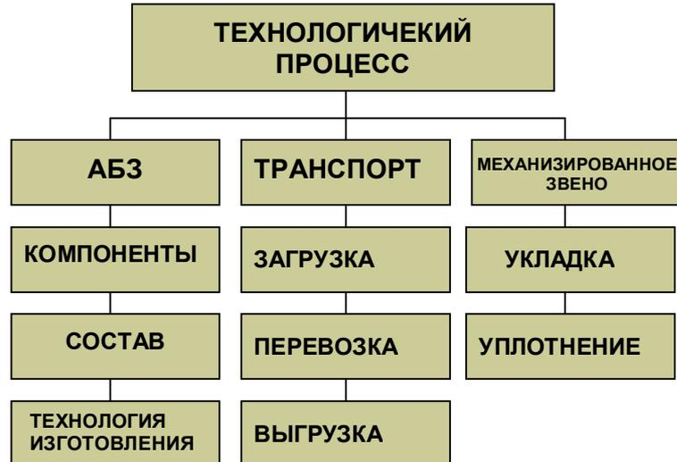
Рис. 1 Структурная схема технологического процесса строительства асфальтобетонного покрытия
