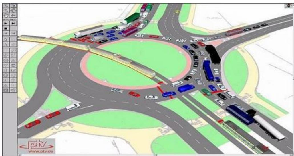
Рис. 2. Результаты работы программного комплекса VISSIM при моделировании кругового движения
