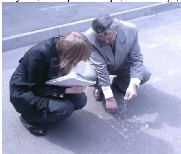
Фото 1. Натурные измерения шероховатости покрытия
