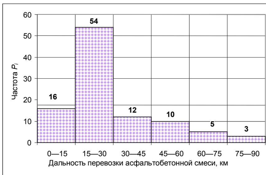
Рис. 2. Гистограмма дальности перевозки асфальтобетонной смеси на объекты дорожного строительства Волгоградской области
