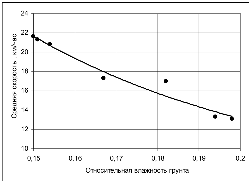
Рис.1. Оценка точности расчета скорости автосамосвала КрАЗ 256Б по грунтовой дороге
