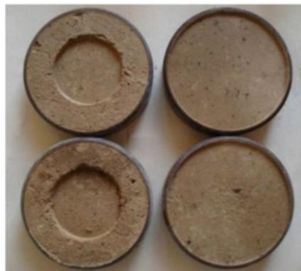
Рис. 3. Внешний вид устройства: *a* — штамп, патент № 56742. E02D 1/04 (2011.01); *б* — образцы грунта после испытания на запатентованном устройстве (слева) и на компрессионном приборе (справа)
