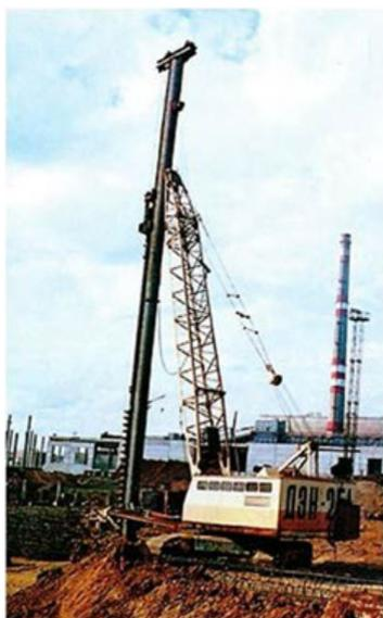
Рис. 2.1. Буровая установка СО-2
