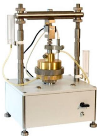
Рис. 1. Прибор для компрессионного сжатия
