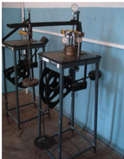
Рис. 4. Вид визготовленного устройства [14] для определения характеристик деформируемости грунта с возможностью его бокового расширения
