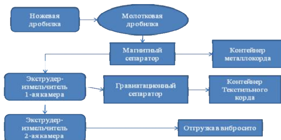
Рис.1. Технологическая схема получения резинового порошка
