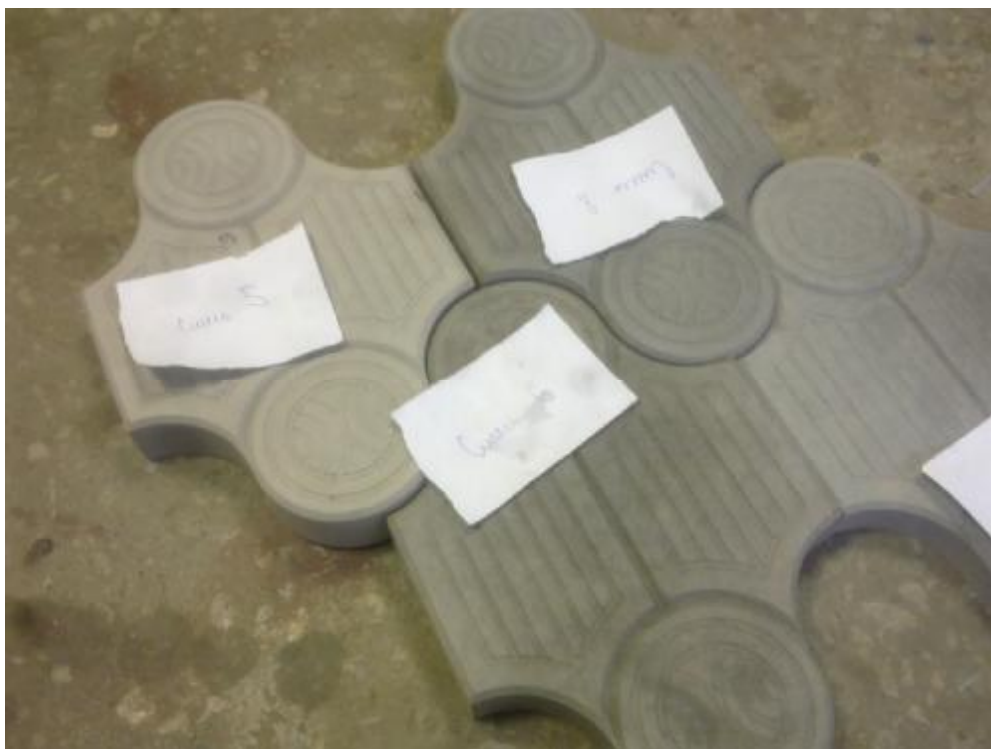
Рис. 2 Образцы тротуарной плитки изготовленной с применением шлакового щебня
