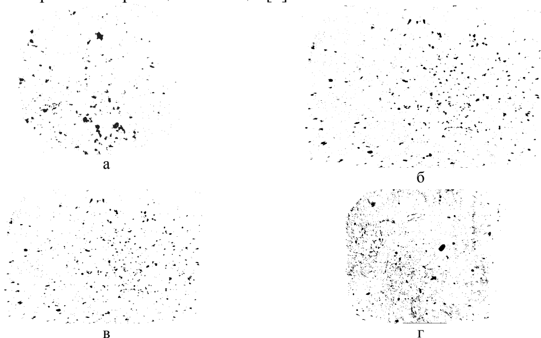
Рис. 1 Изображение частиц пыли под микроскопом: а – в системе аспирации после сушильного барабана; б – после пылеуловителя первой ступени в системе аспирации сушильного барабана; в – от складов инертных материалов; г – в зоне обслуживания инертных материалов
