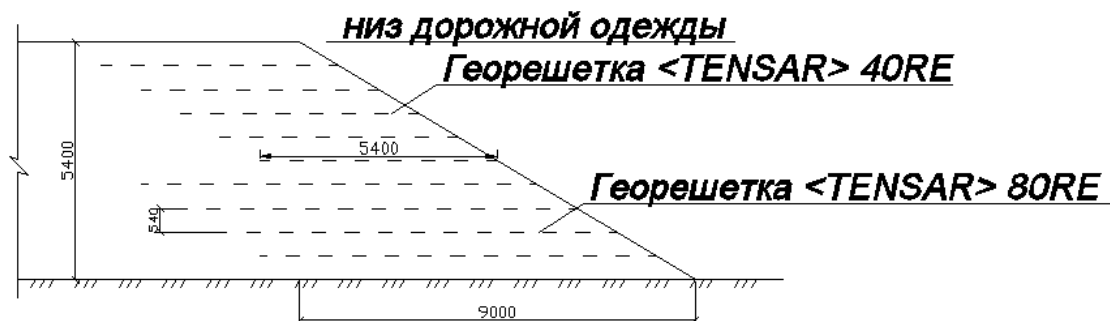
Рис.1 Конструкция армированной насыпи
