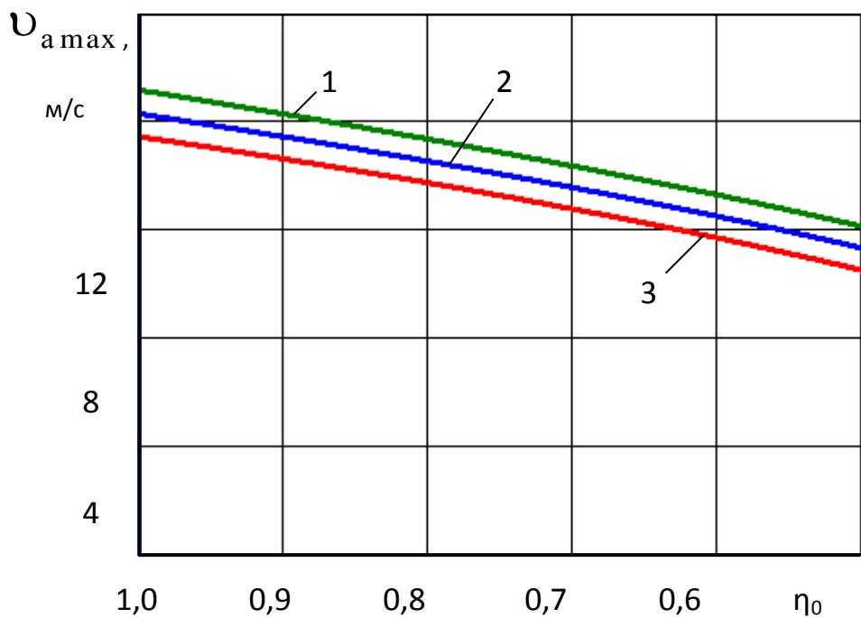
Рис. 2. Зависимость критической скорости от коэффициента устойчивости автобуса при различных значениях угла наклона дороги 1 –  $0^\circ$ ; 2 –  $3^\circ$ ; 3 –  $6^\circ$
