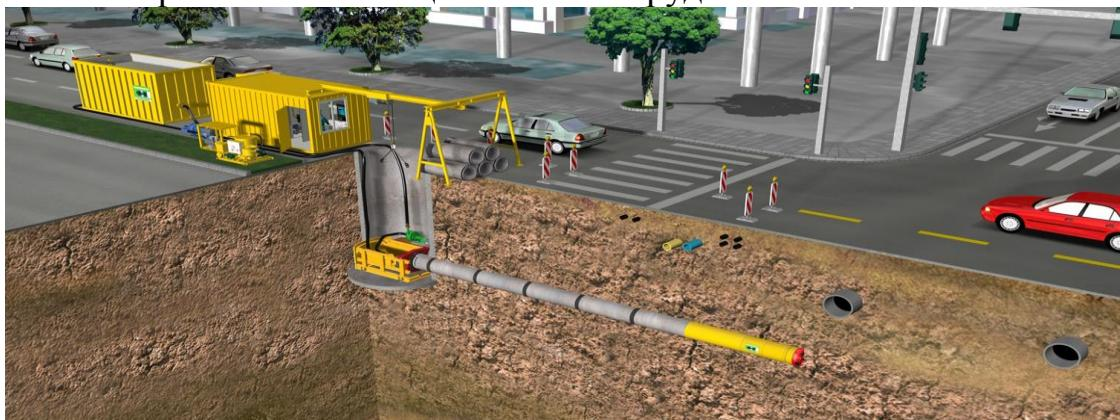
Рис. 1 Пример работы бесструнштейной установки без остановки движения на проезжей части
