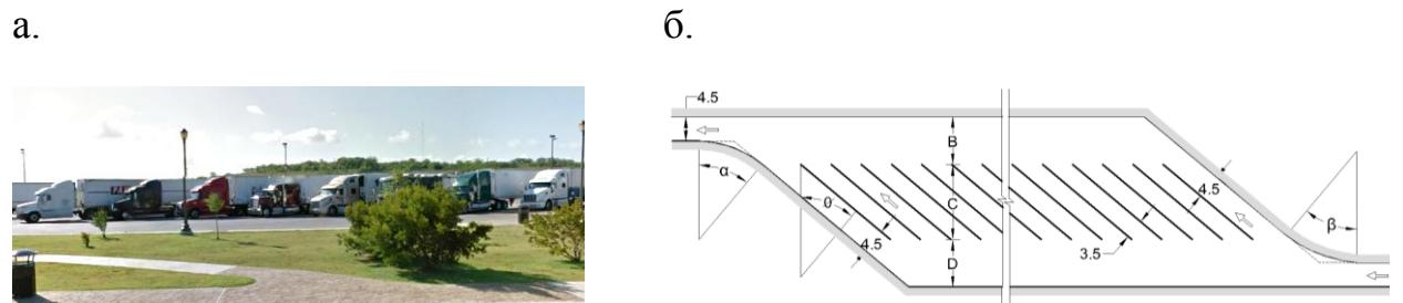
Рис. 3. Общий вид (а) и разбивка парковочных мест для крупногабаритных грузовых автомобилей с расположением парковочных мест под углом
