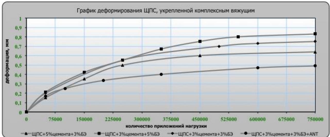
Рис. 3. График испытаний устойчивости щебено-песчаных смесей, укрепленных комплексным вяжущим к накоплению остаточных деформаций
