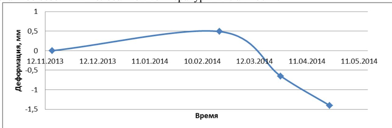
Рис. 4. График изменения толщины грунта земляного полотна в течение 5 месяцев наблюдения
