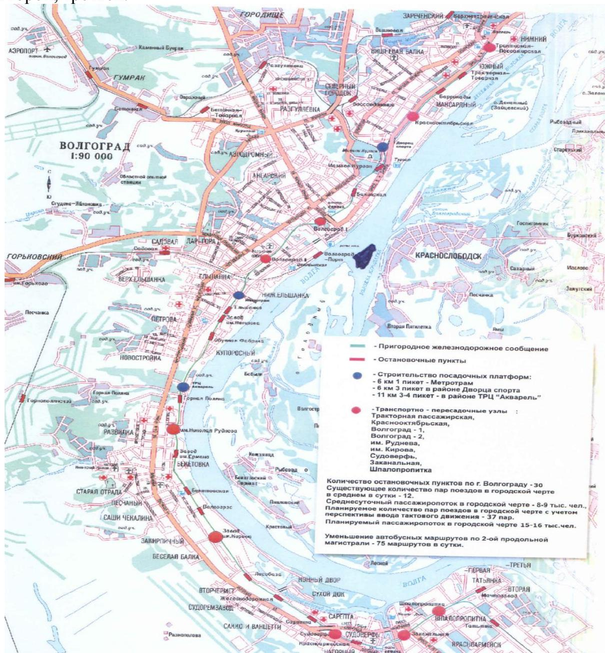
Рис. 9. Схема железнодорожного транспортного диаметра с 9 модернизируемыми транспортно-пересадочными узлами на территории города Волгограда<sup>1</sup>
