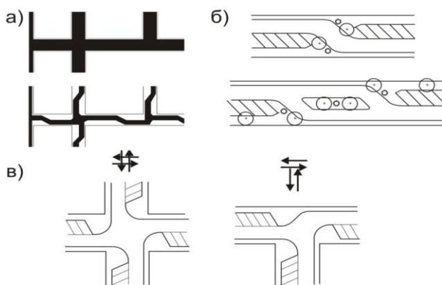
Рис. 13. Мероприятия по «успокоению движения» с использованием искусственных препятствий изменяющих траекторию движения [6]
