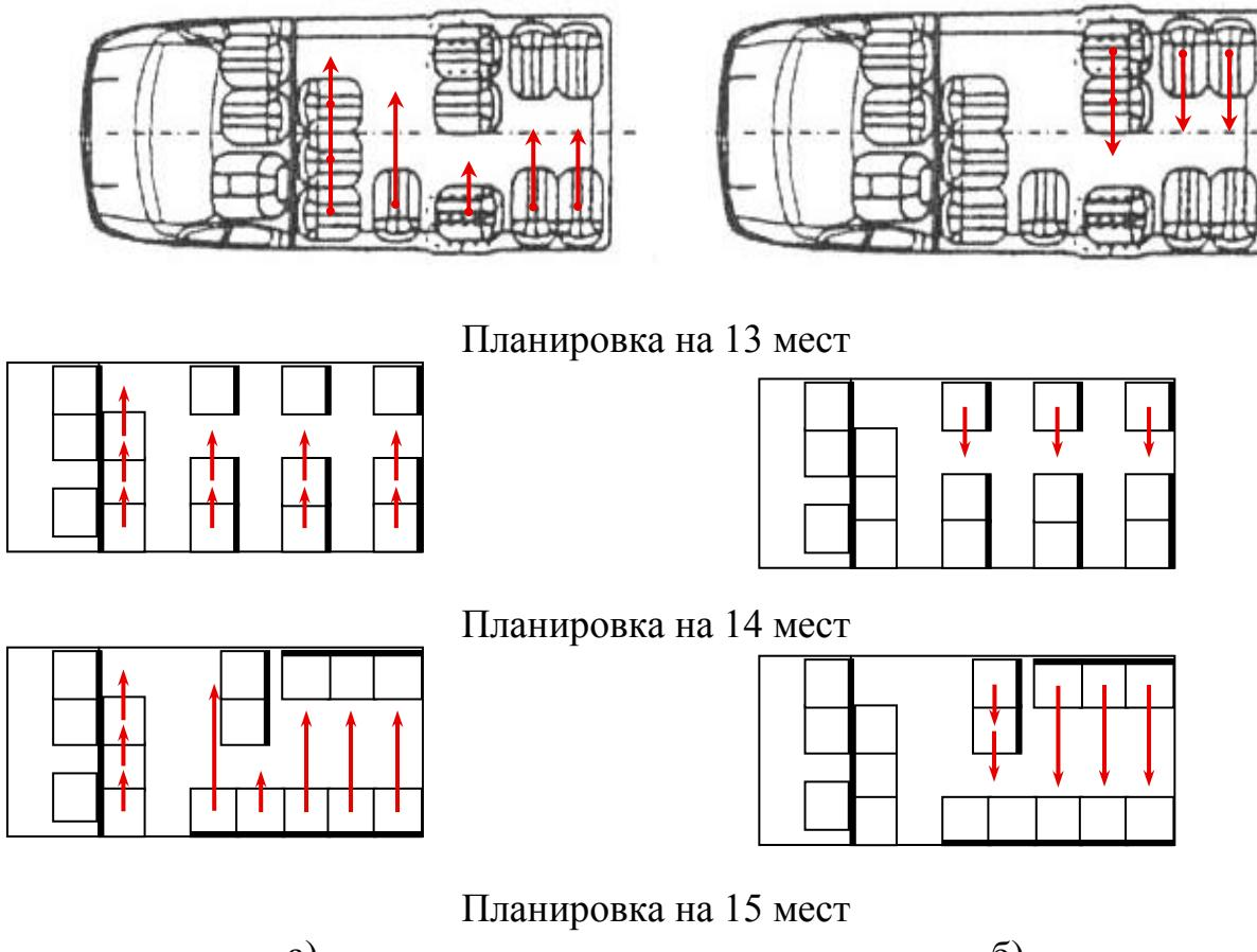
Рис. 1. Схемы возможных перемещений пассажиров по инерции на поворотах в салоне микроавтобусов «ГАЗель» с различной планировкой: а) на левом повороте; б) на правом повороте
