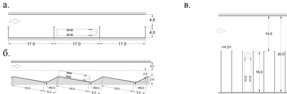
Рис. 2. Схема разбивки парковочных мест автобусов при их параллельном (а), пилообразном (б) и перпендикулярном (в) размещении по отношению к проезду
