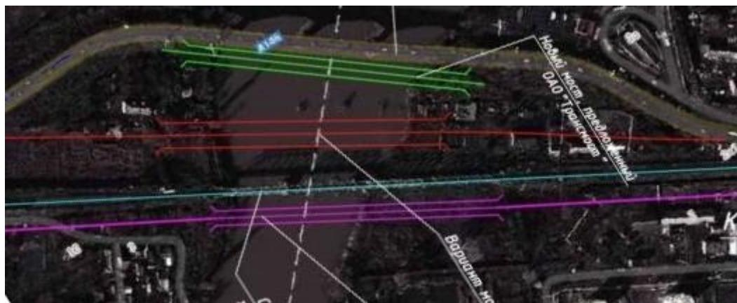
Рис. 4. Новый мостовой переход в районе существующего моста
