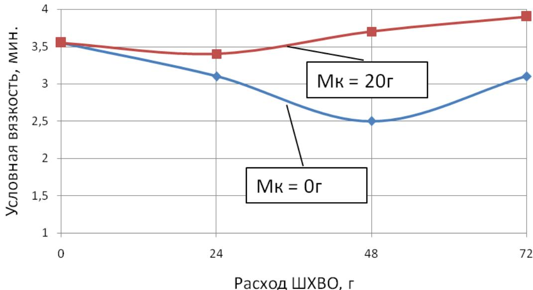
Рис. 1. Условная вязкость цементного теста
