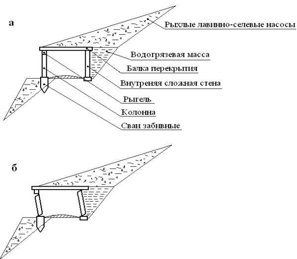
Рис. 2. Схема лавинозащитной галереи до (а) и после (б) деформации
