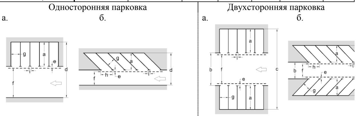
а – глубина стояночного места; б – ширина проезда между рядами парковочных мест; д – ширина полосы для парковки транспортных средств и проезда; е – полоса безопасности; ф – полоса маневрирования; г – ширина парковочного места; *h* - ширина парковочного модуля при размещении автомобилей под углом к проезду; *i* – длина линии разметки 1.1.
