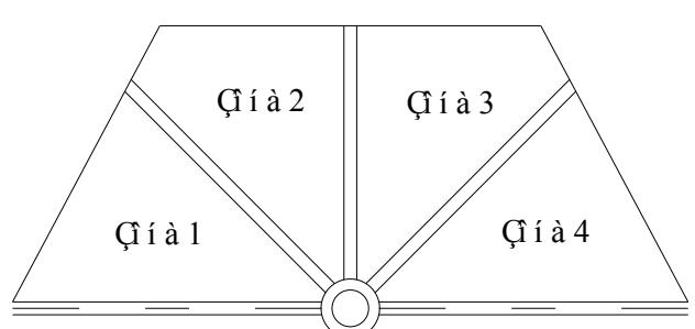
Рис. 2. Схемы парковочных площадок с применением малых кольцевых пересечений
