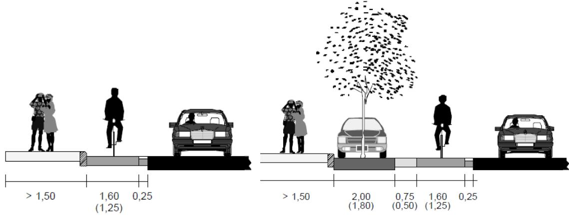
Рис. 16. Устройство пешеходных зон, транспортных и прогулочных велосипедных дорожек
