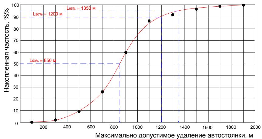
Рис.2. Кумулятивная кривая максимально допустимой удаленности домов автовладельцев от автостоянки (по данным опроса)
