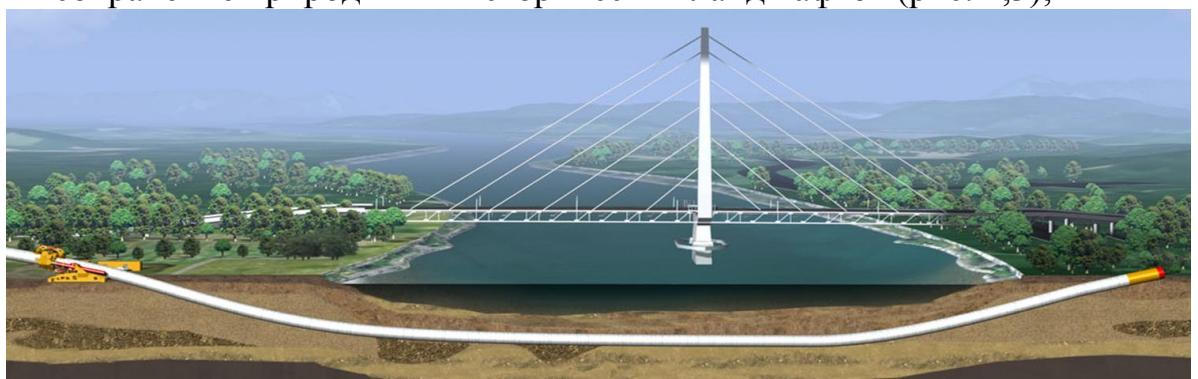
Рис. 2. Пример работы бесструнштейной установки при прокладке тоннеля под рекой за пределами города
