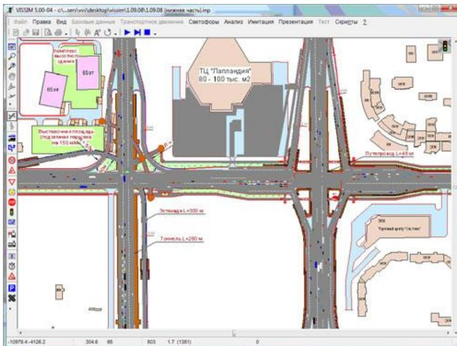
Рис. 2. Микромоделирование сети дорог в г. Кемерово в пакете VISSIM
