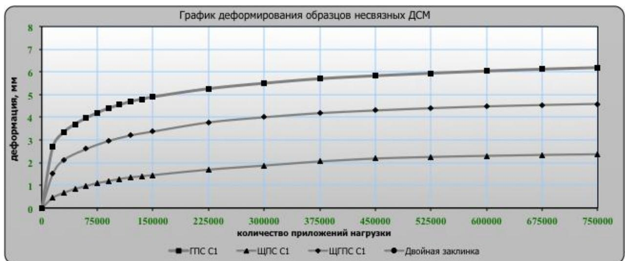
Рис. 1. График испытаний устойчивости несвязных дорожно-строительных материалов к накоплению остаточных деформаций
