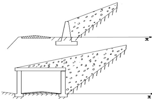
Рис. 1. Схема сопряжения защитного сооружения и запазушной рыхлой массы
