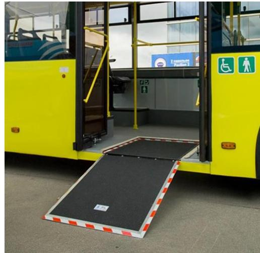
Рис. 4. Низкопольный автобус, приспособленный для перемещения людей в инвалидных колясках
