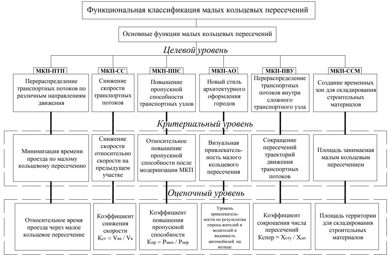
Рис. 1 Функциональная классификация малых кольцевых пересечений по целевому признаку
