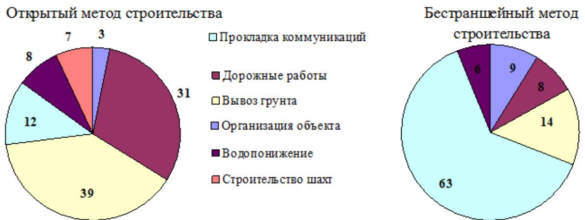
Рис. 3. Диаграммы сравнения затраченных ресурсов при двух методах строительства траншейном и бестраншейном [2]
