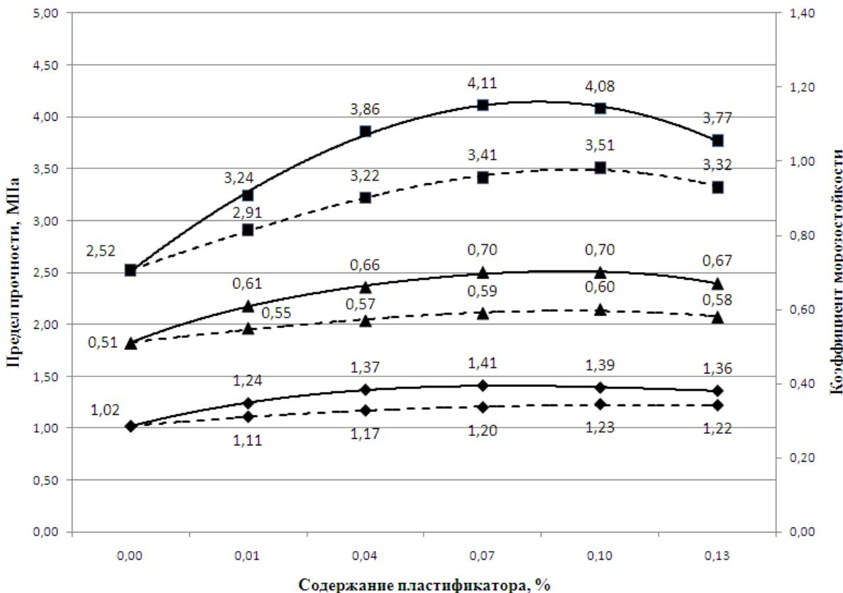
Рис. 1. Зависимость физико-механических свойств цементогрунта от содержания пластификатора:
