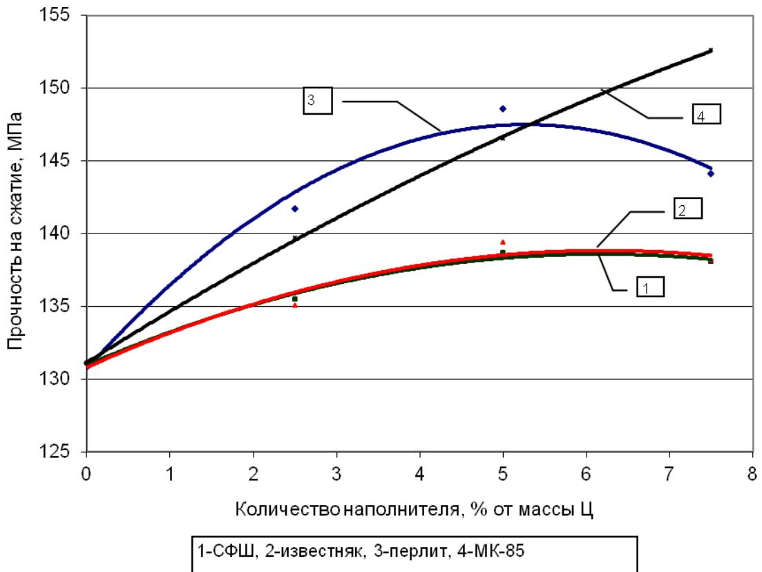
Рис. 1. Влияние дозировки и вида наполнителей на прочность цементного камня на сжатие в возрасте 28 суток
