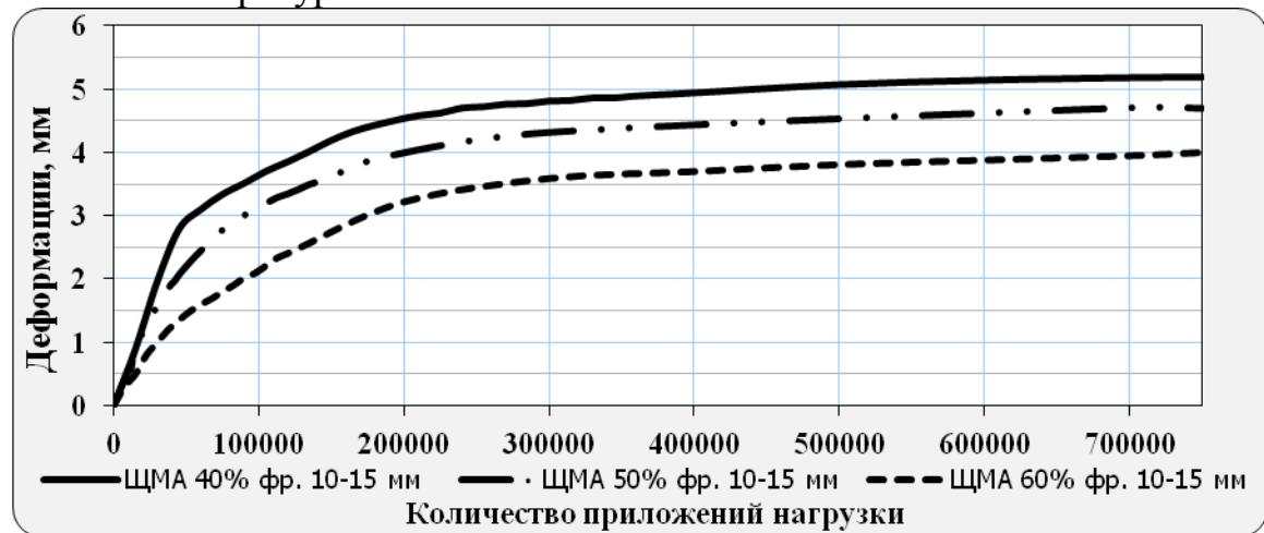
Рис. 2. Характер зависимостей остаточных деформаций щебеноно-мастичного асфальтобетона от 750 000 приложений расчетной нагрузки при варьировании содержания крупных фракций щебня
