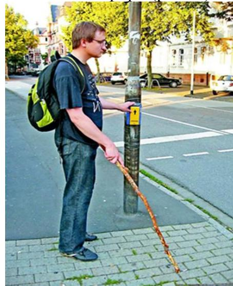
Рис.5. Светофор с кнопкой, которая вибрируют на зеленый свет
