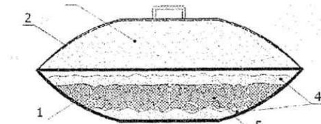
Рис. 3: 1-сосуд; 2-крышка сосуда; 3-теплоизолят; 4-слой негашеной извести; 5-слой твердого нефтешлама (ТНШ).
