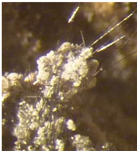
Рис. 2. Микроскопическое изображение внутренней структуры скола образца ЦВКУ (2,0 % ОУВ), (МБС-9 (4,0 – 14 х ))
