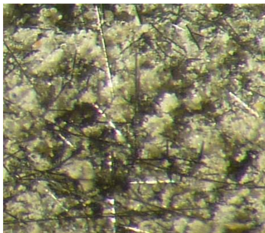
Рис. 6. Микроскопическое изображение структуры оптимального состава ЦВКУ, поверхность не шлифованная (МБС-9 (7,0 – 14 x ))
