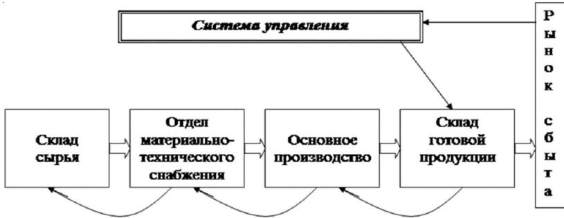
Рис. 2. Тянущая система управления материальным потоком на предприятии стройиндустрии [8]
