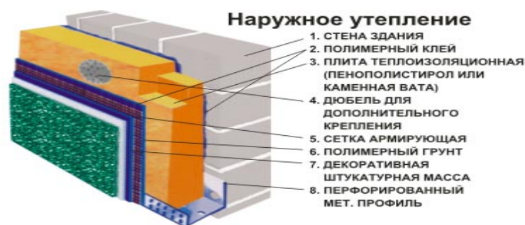
Рис. 1. Система наружного утепления[1,5]
