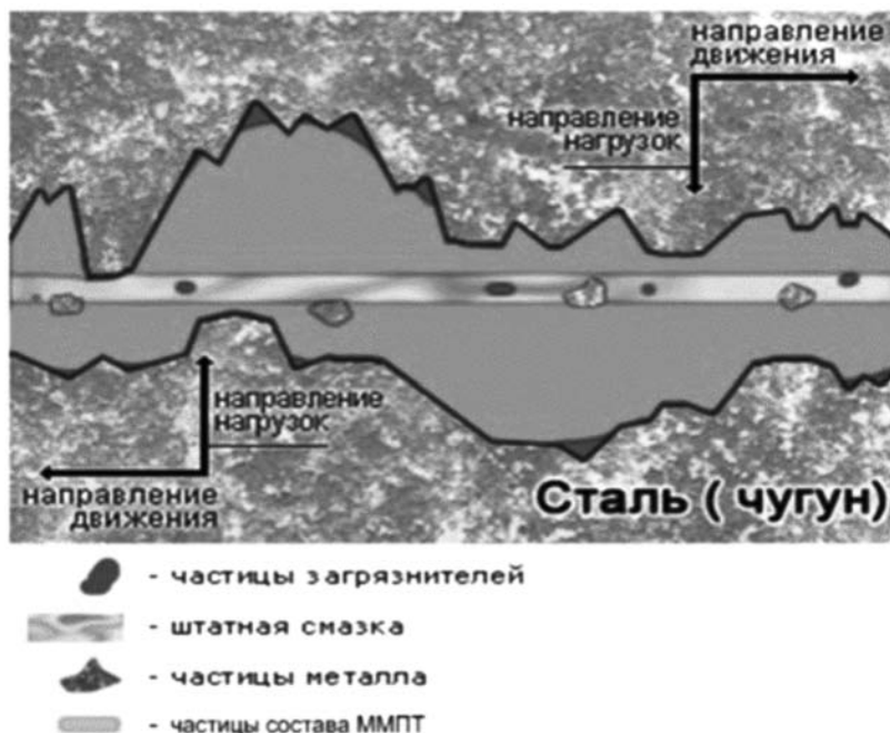
Рис. 5. Образование металлокерамического защитного слоя
