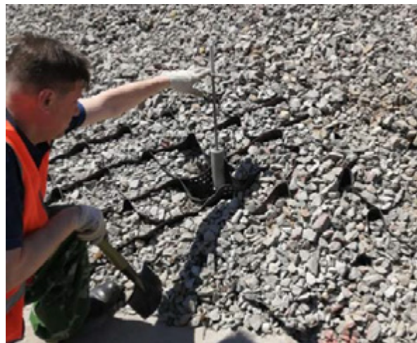
Рис. 13. Определение плотности грунта откоса динамическим плотномером
