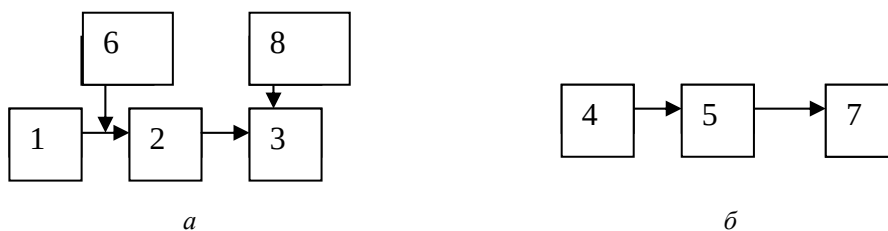
Рис. 2. Схемы передающего (а) и приемного (б) трактов: 1 — звуковой генератор; 2 — усилитель мощности; 3 — генератор механических колебаний ГМК-1; 4 — вибродатчик; 5 — предварительный усилитель; 6 — частотомер; 7 — ламповый вольтметр; 8 — миллиамперметр
