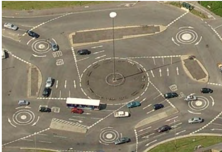
Рис. 14. Пример сложной кольцевой развязки с применением мини-КП для разделения потоков в Великобритании [19]
