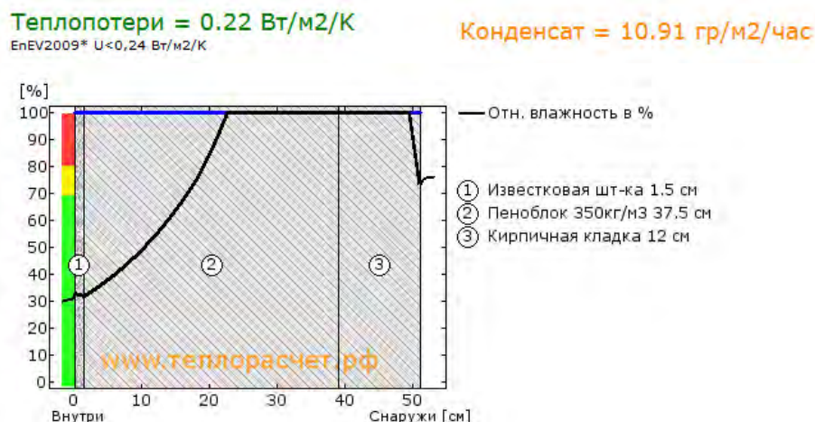
Рис. 2. График относительной влажности в стене по первому варианту расчета без использования утеплителя
