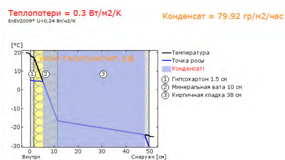
Рис. 1. Расчетная схема 1: верхний график — падение или увеличение температуры внутри ограждающей конструкции; нижний график — температура точки росы; серым цветом выделена зона возможной конденсации
