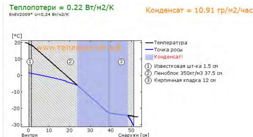
Рис. 1. График температур в стене по первому варианту расчета
