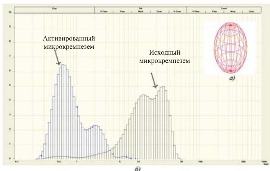
Рис. 4. Данные исследования системы комплексной добавки методом лазерной дифракции через 12 ч после синтеза: *а* — модель формы частиц гидрозоля кремния; *б* — график распределения размера частиц гидрозоля кремния в объеме системы
