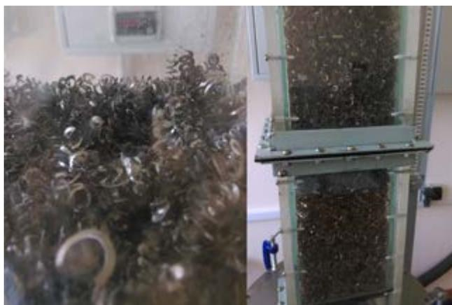
Рис. 1. Фото насадочных элементов и укомплектованного насадочного картриджа для осуществления классифицирующих экспериментальных исследований
