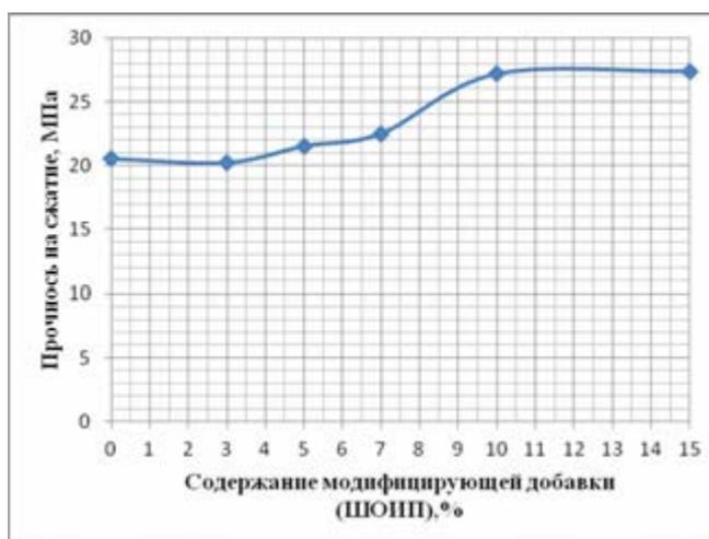
Рис. 2. Прочность на сжатие мелкозернистого бетона, модифицированного отходами инструментальной промышленности
