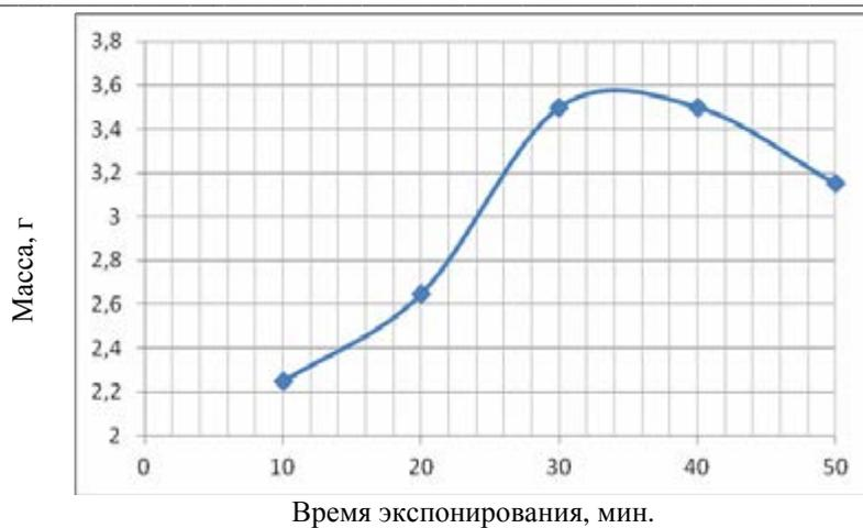
Рис. 3. Кинетика массопоглощения полимерного связующего в 5 % растворе HCl
