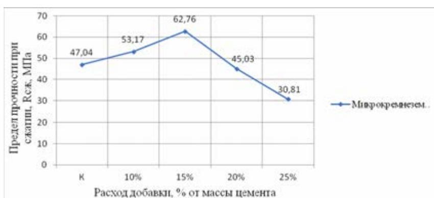
Рис. 1. Зависимость предела прочности бетона при сжатии от расхода добавки
