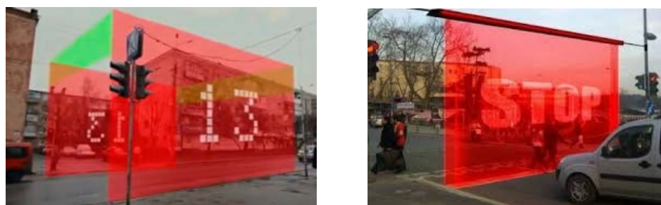
Рис. 10. Лазерная стена светофорного объекта на УДС
