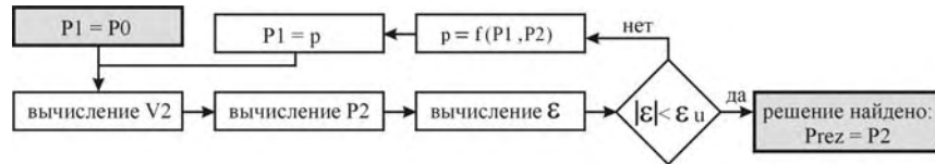
Рис. 2. Поиск давления воздуха внутри деформированной оболочки
