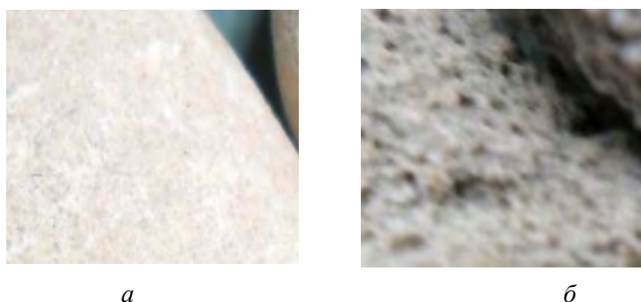
Рис. 5. Микрофото поверхности зерен порошков: a — из доломитов; б — из отвалных кеков
