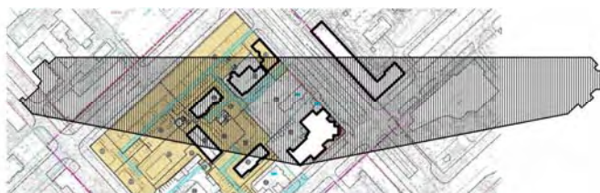
Рис. 1. Схема определения зоны влияния проектируемого здания
