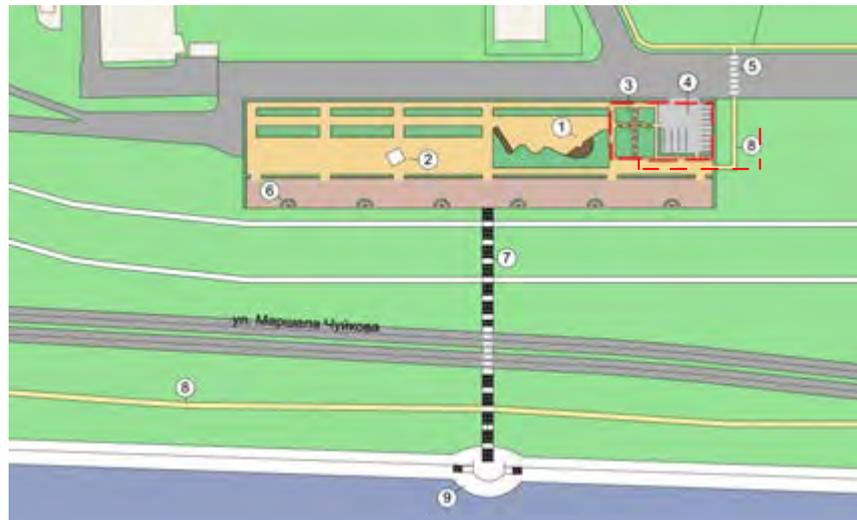
Рис. 2. Схема проектного предложения по благоустройству историко-мемориальной зоны на территории ЦПКиО: 1 — Стена памяти; 2 — часовня; 3 — сквер; 4 — наземно-подземная стоянка; 5 — пешеходный переход; 6 — смотровые площадки; 7 — лестничный спуск; 8 — пешеходные дорожки; 9 — смотровая площадка на берегу Волги
