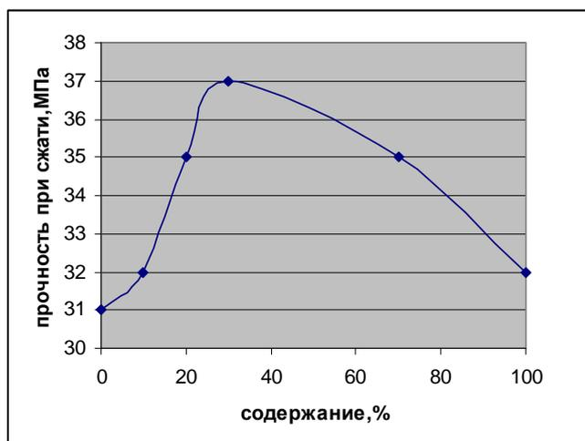
Рис. 3. Зависимость изменения прочности при сжатии от содержания обточки
