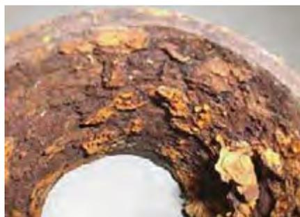
Рис. 1. Фрагмент металлической канализационной трубы, подвергшейся воздействию сероводорода
