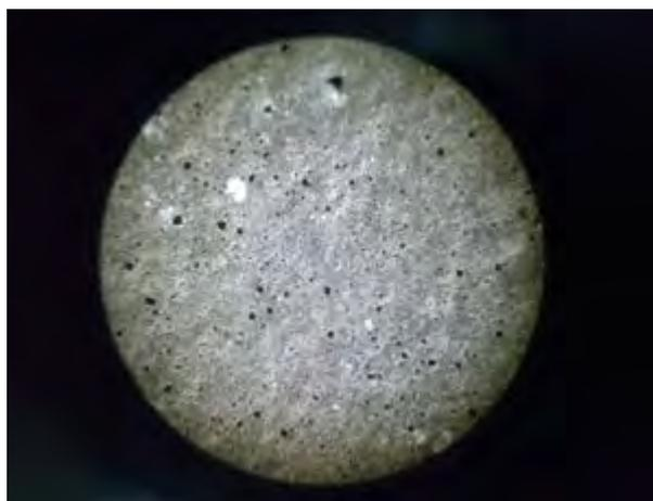
Рис. 4. Покрытие на основе калиевого полисиликатного раствора
