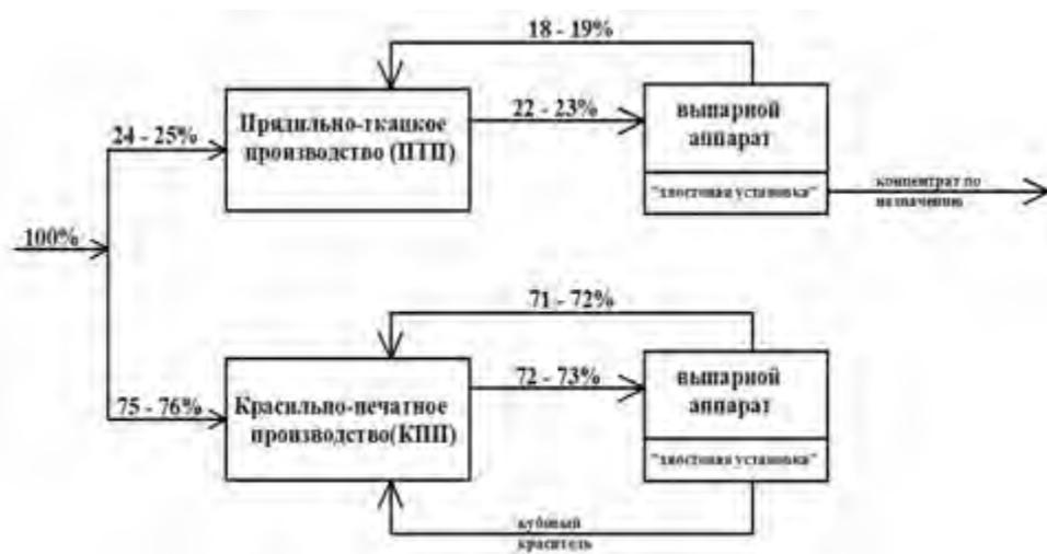
Рис. 3. Балансовая схема водоснабжения текстильного предприятия
