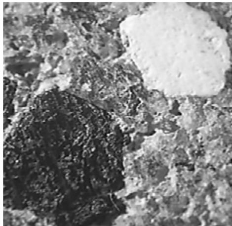
Рис. 2. Структура образцов бетона с заполнителем — металлургическим шлаком: увеличение  $25\times$  [1]
