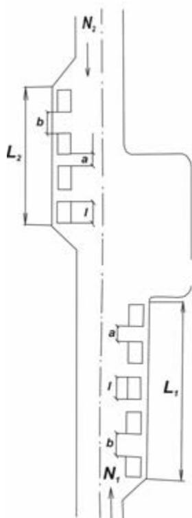
Рис. 6. Расчетная схема к определению дополнительной полосы на участках подъездов к зерновым заготовительным пунктам при двухстороннем поступлении уборочного транспорта с интенсивностью  $N_1$  и  $N_2$
