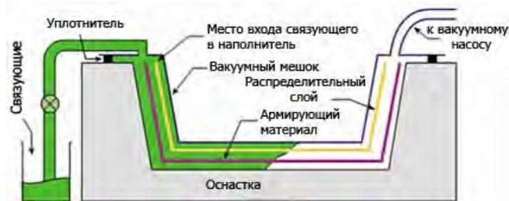
Рис. 1. Схема вакуумной инфузии
