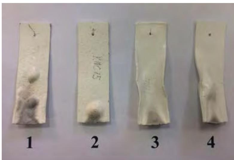
Рис. 1. Внешний вид образцов после испытаний на горючесть по методу «Огневая труба»: 1 — покрытие на основе калиевого жидкого стекла; 2 — покрытие на основе калиевого полисиликатного раствора; 3 — покрытие на основе натриевого жидкого стекла; 4 — покрытие на основе натриевого полисиликатного раствора
