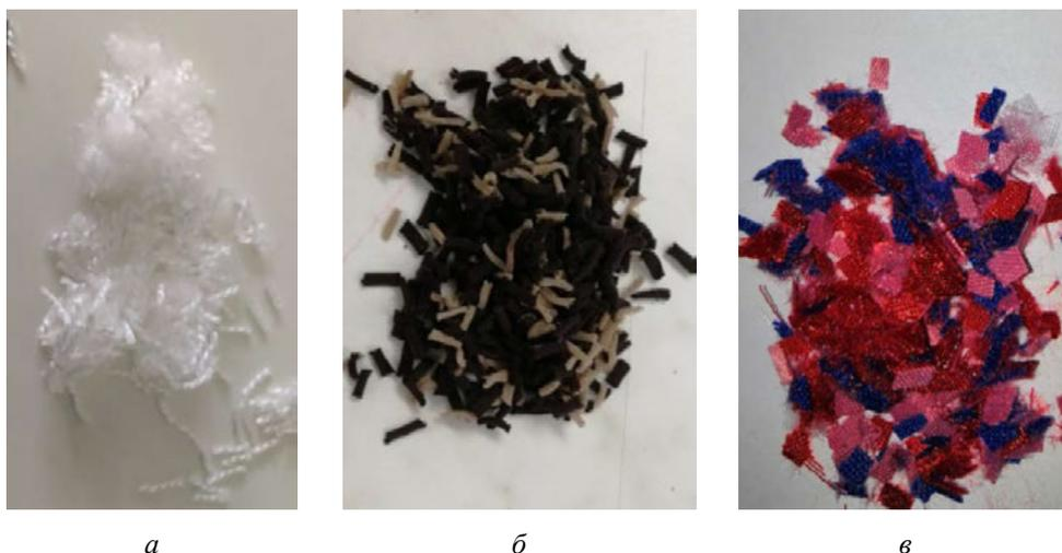
Рис. 1. Общий вид синтетических полимерных волокон: *а* — полиамидная нить; *б* — полиамидные волокна (отходы капроновых изделий); *в* — поливолокна, состоящие из отходов тканевых продуктов
