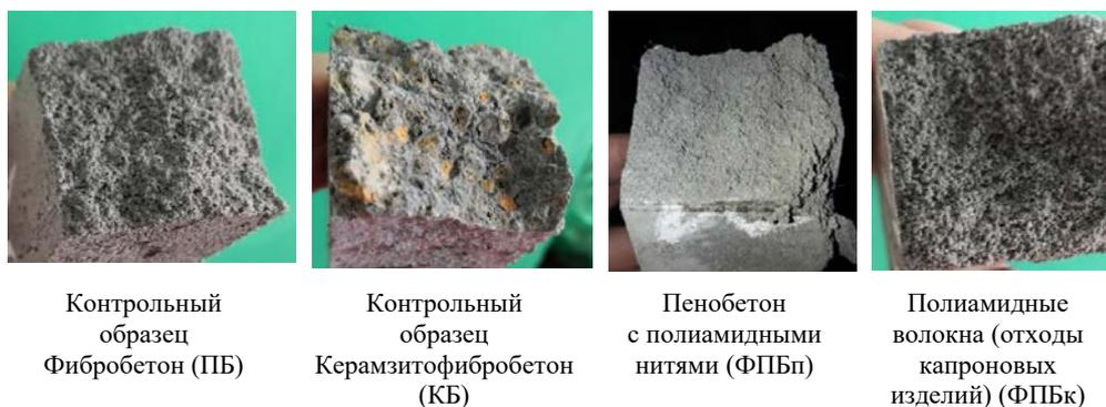
Рис 2. Общий вид структуры образцов
