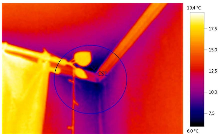
Рис. 4. Снимок тепловизора на внутренней поверхности в углу жилого помещения
