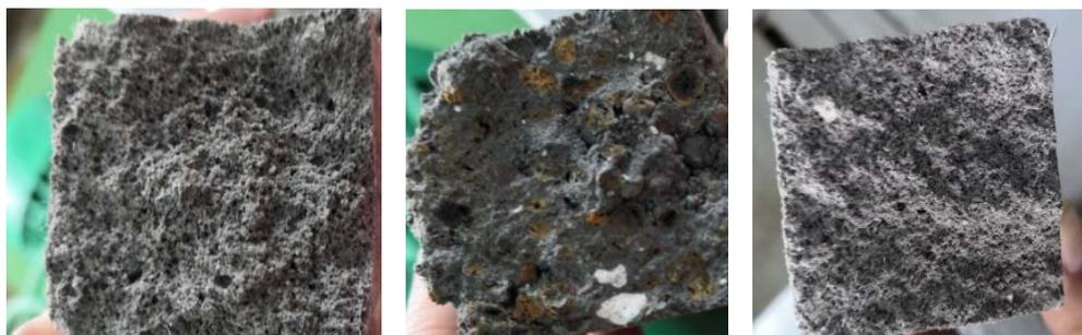
Рис. 3. Общий вид структуры образцов с модифицированной фиброй
