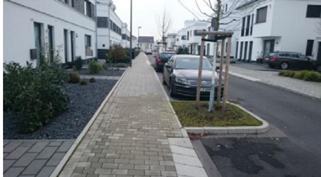
Рис. 4. Парковка в кармане за направляющим островком
