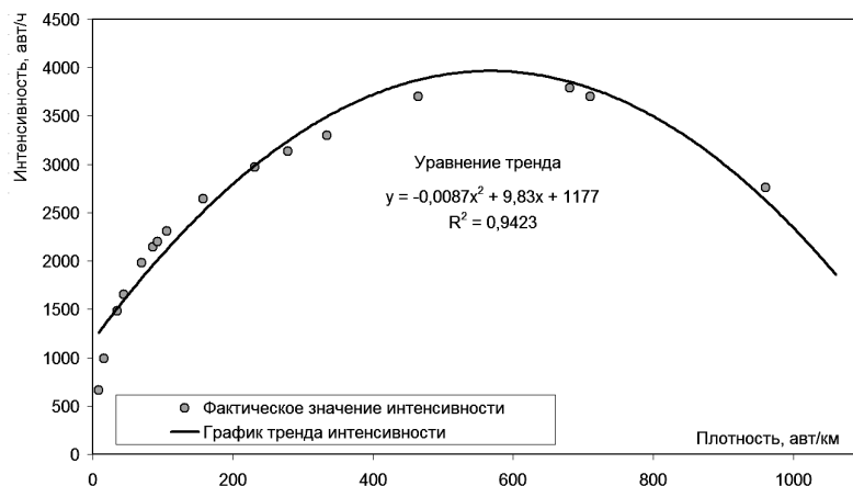
Рис. 6. Основная диаграмма состояния транспортного потока
