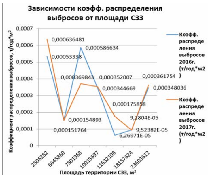
Рис. 3. Зависимость коэффициента распределения выбросов от площади СЗЗ
