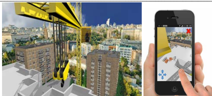
Рис. 6. Отображение панорамы объекта на мобильном устройстве с использованием видеонаблюдения
