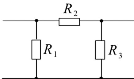
Это означает, что  $R_2 = \frac{U_2}{I_2} = \frac{60}{1} = 60$  (Ом). Так как через сопротивление  $R_3$  в первом случае идет такой же ток, что и через сопротивление  $R_2$ , то  $R_3 = \frac{U_3}{I_2} = \frac{40}{1} = 40$  (Ом).
