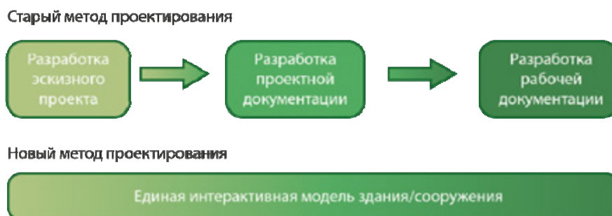
Рис.1. Блок схема, иллюстрирующая сравнение старого метода проектирования с новым
