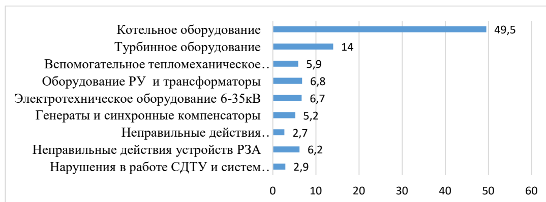
Рис. 1 Аварийность на объектах электроэнергетики СФО по видам энергооборудования за 2022 год.
