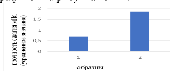
Рис. 3. Испытание на прочность сжатия, где 1 - образцы, не прошедшие аппарат вихревого слоя, 2 - образцы, прошедшие аппарат вихревого слоя (пыль 20%)
