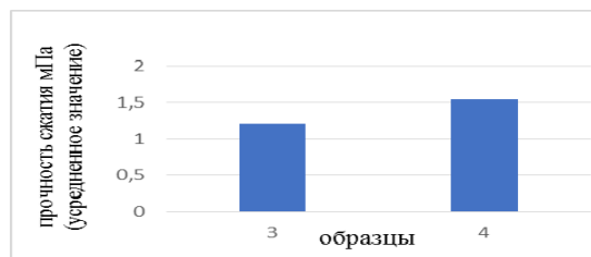
Рис. 4. Испытание на прочность сжатия, где 3 - образцы, не прошедшие аппарат вихревого слоя, 4 - образцы, прошедшие аппарат вихревого слоя (шлак 20%)
