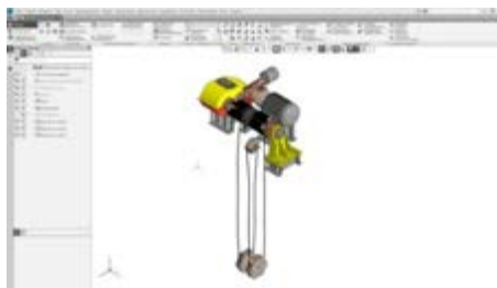
Рис. 1. Крановый редуктор подъёма груза на 5 тонн
