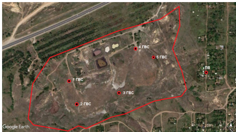
Рис. 3. Схема отбора проб воздуха и газо-воздушной смеси: ПВ — отбор пробы атмосферного воздуха; 1—5 ГВС — отбор проб газо-воздушной смеси
