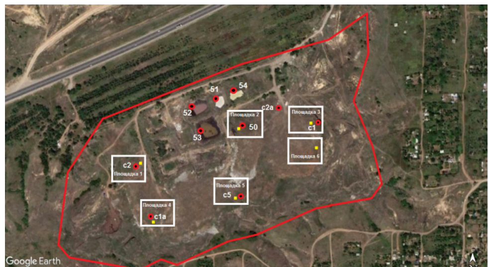
Рис. 5. Схема отбора проб грунтов: площадка 1—6 — пробные площадки; с1, с1а, с2, с2а, с5 — скважины участка; 50—54 — скважины территории свалки с отстойниками нефтепродуктов
