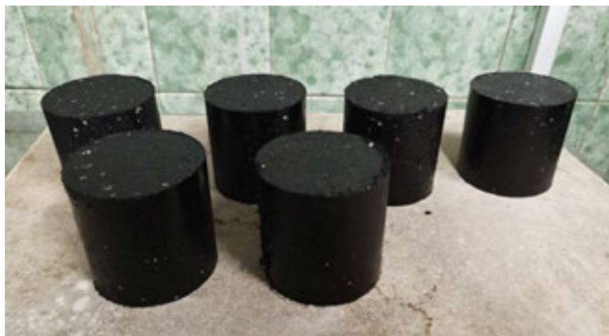
Рис. 3. Образцы асфальтобетона с применением минерального порошка из ОФС
