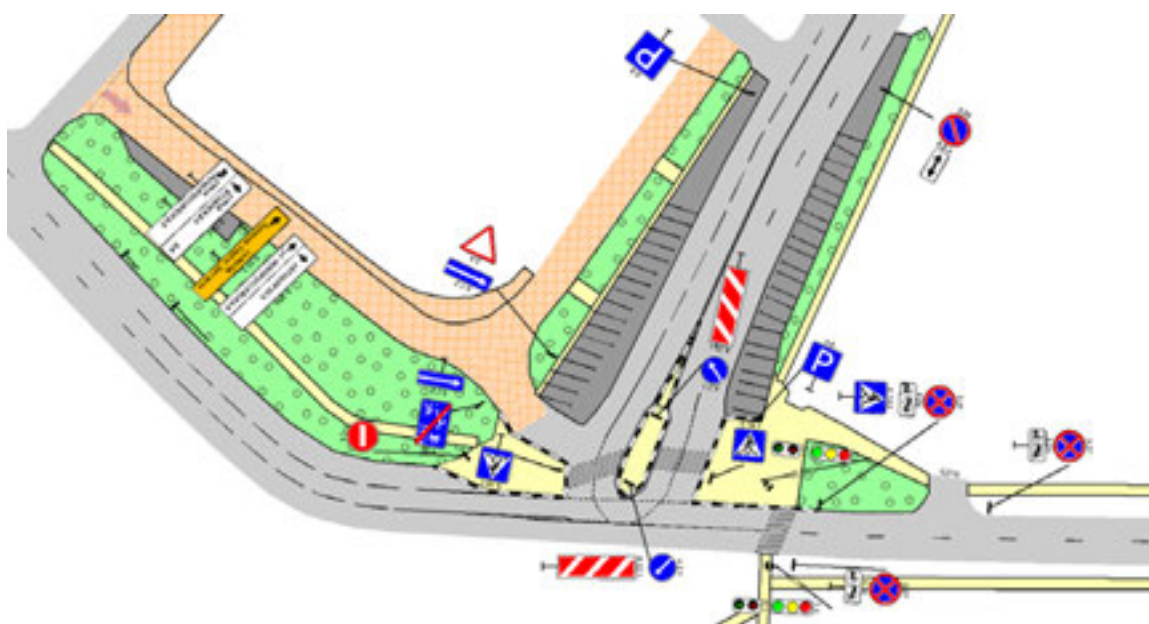
Рис. 5. Пример проектного решения со схемой ОДД транспортного узла ул. Голубинская – ул. Новороссийская – ул. Балонина г. Волгограда
