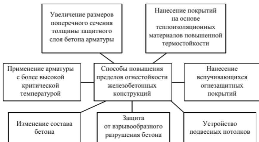
Рис. 4. Способы повышения пределов огнестойкости железобетонных конструкций
