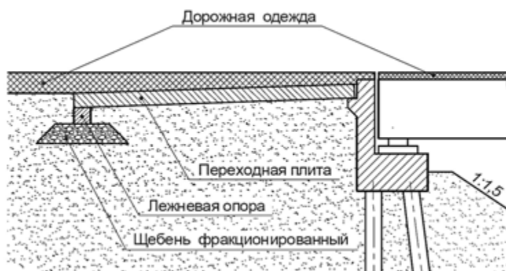
Рис. 2. Сопряжение мостового сооружения с насыпью
