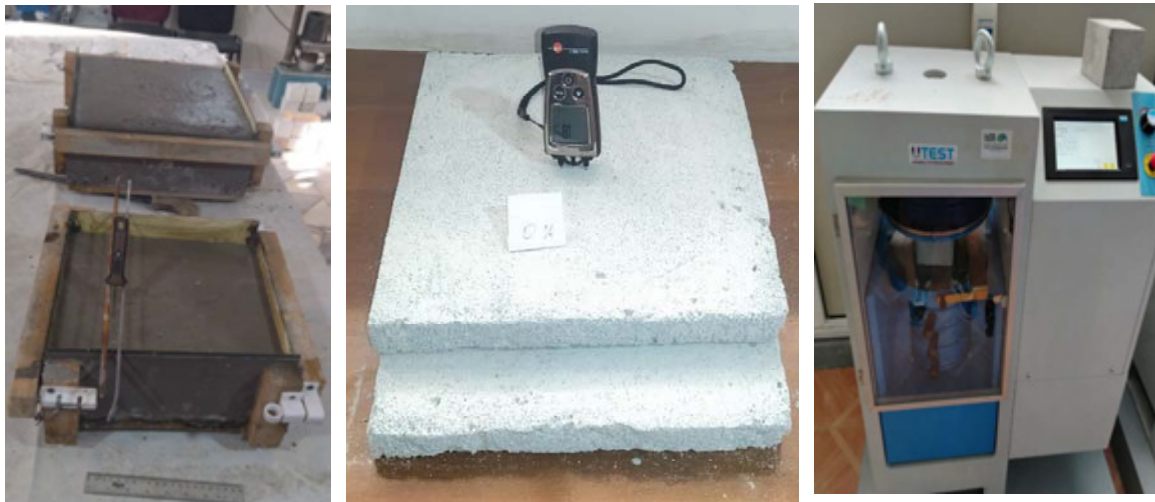
Рис. 1. а) приготовление образцов газобетона; б) определение содержания влаги в образцах, подготовленных для определения коэффициента теплопроводности; в) процессы испытания образца на сжатие
