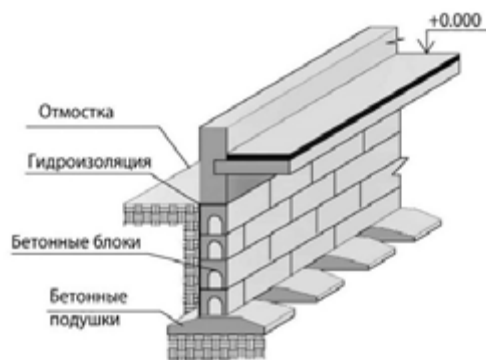
Рис. 1. Конструкция прерывистого ленточного фундамента
