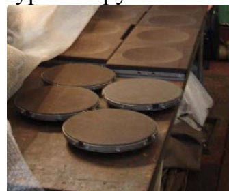
Рис. 1: а – антифрикционная ткань «Даклен-1» под микроскопом; б – изготовление опорных частей с использованием даклена
