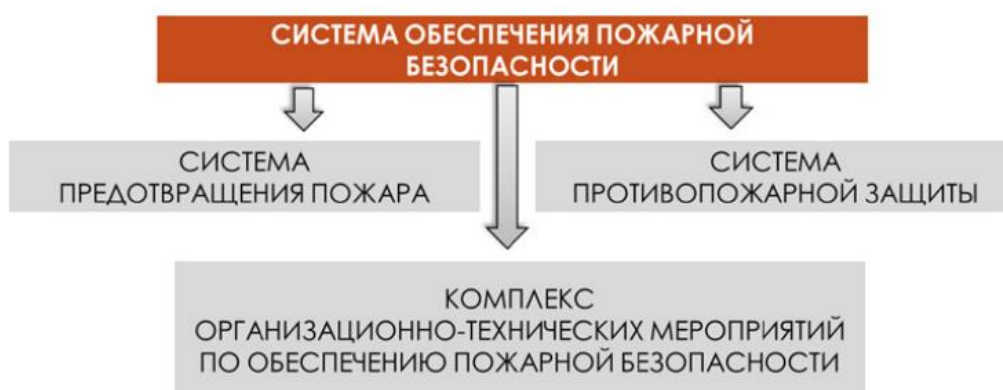
Рис.1. Схема комплексного подхода в обеспечении пожарной безопасности музеев и фондохранилищ
