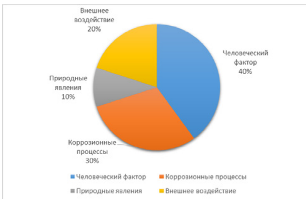
Рис. 1. Причины возникновения аварийных ситуаций ОПО по транспортированию агрессивных жидкостей углеводородов за 2022-2023 года
