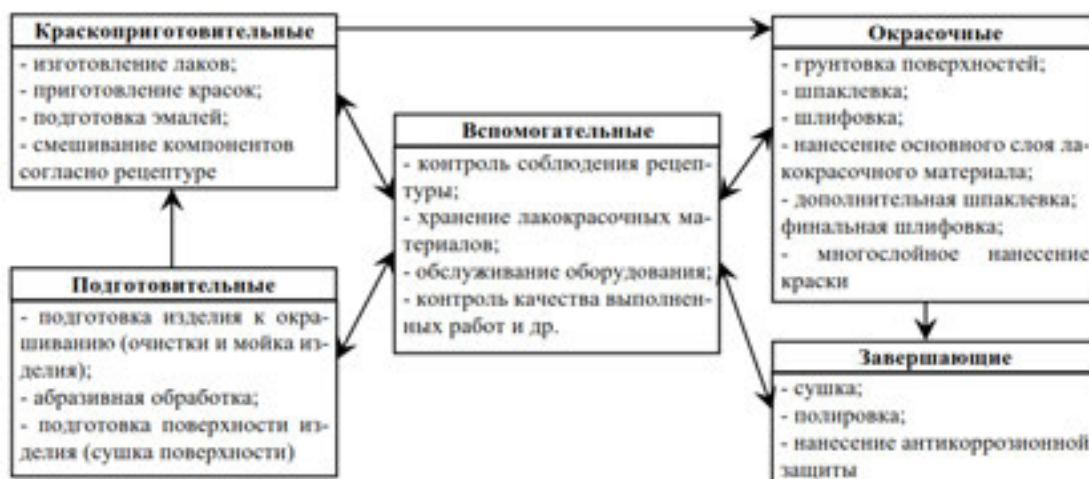
Рис. 1. Последовательность выполнения работ в лакокрасочном цехе
