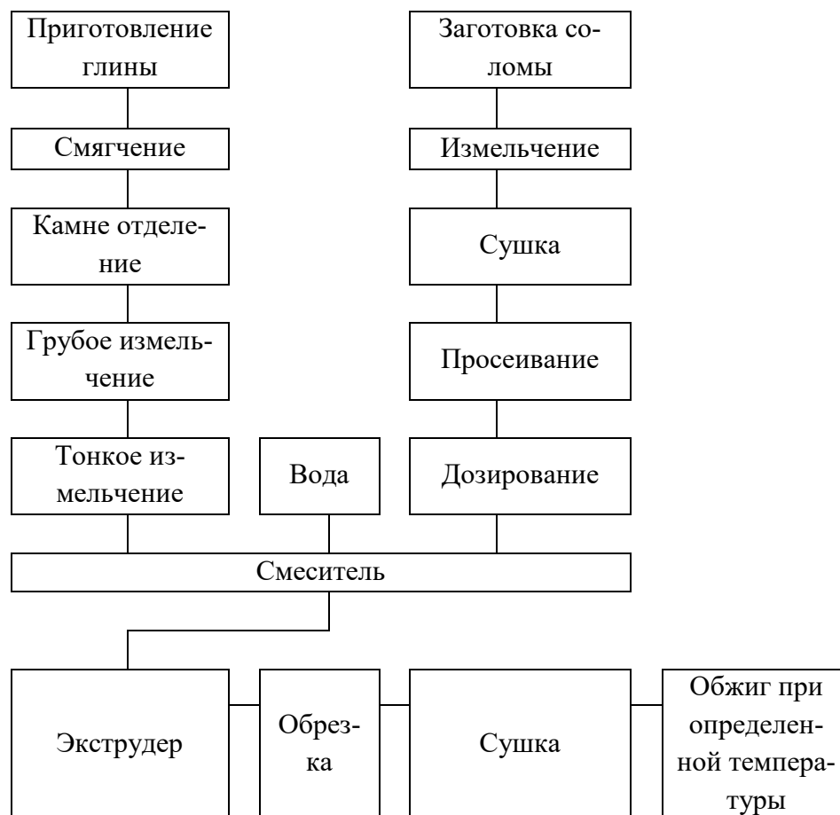
Рис. 2. Принципиальная схема получения керамического кирпича с применением отходов корней солодки.
