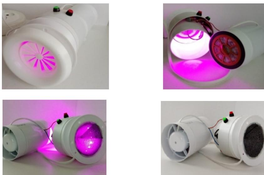
Рис. 2. Экспериментальная приточная установка с фотокаталитическим фильтром со светодиодными источниками УФ-излучения, сорбционными фильтрами
