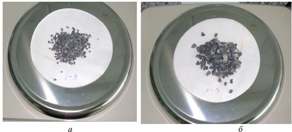
Рис. 2. Опока, диаметр частиц: *a* — 1...3 мм; *б* — 5...7 мм
