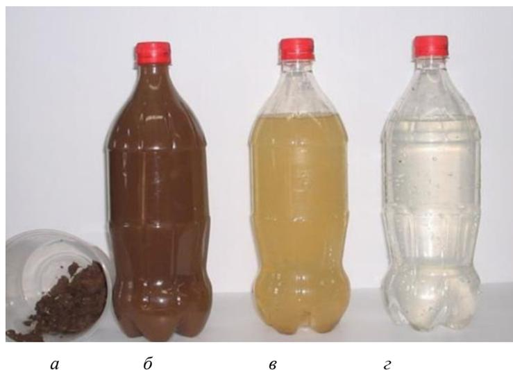
Рис. 6. Результаты отбора проб СВ после каждого этапа очистки:
