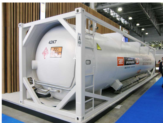
Рис. 3. Криоцистерна для транспортировки СПГ
