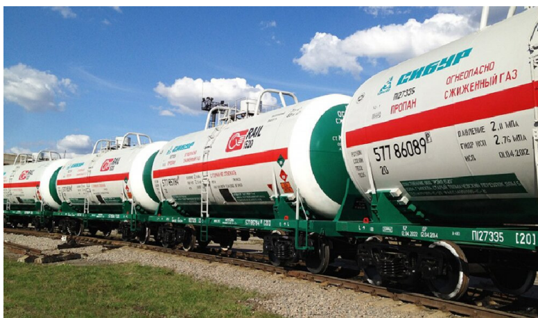
Рис. 1. Транспортировка СГ в вагонах-цистернах
