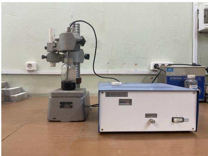
Рис. 1. Диспергатор УЗГ13-01/22
