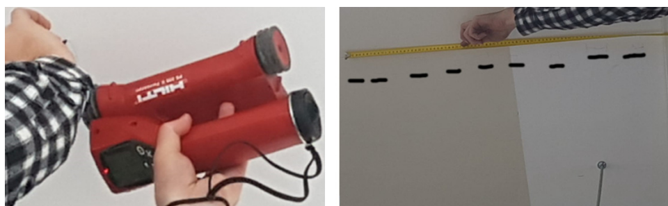
Рис. 6. Сканирование нижней поверхности плит при помощи детектора арматуры Hilti Ferroskan
