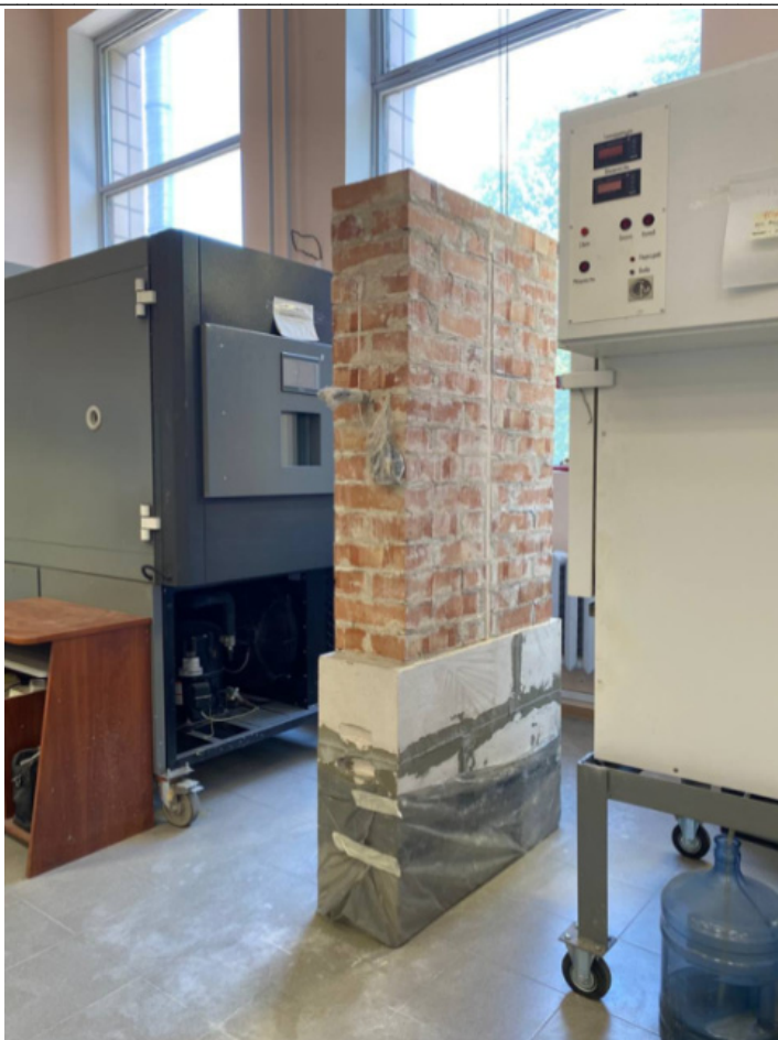
Рис. 3. Фрагменты кладки без штукатурки
