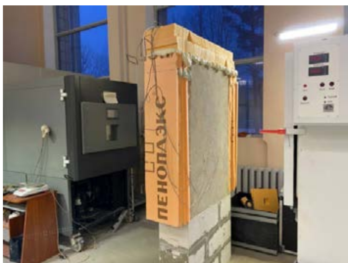
Рис. 4. Испытываемая конструкция после утепления торцов
