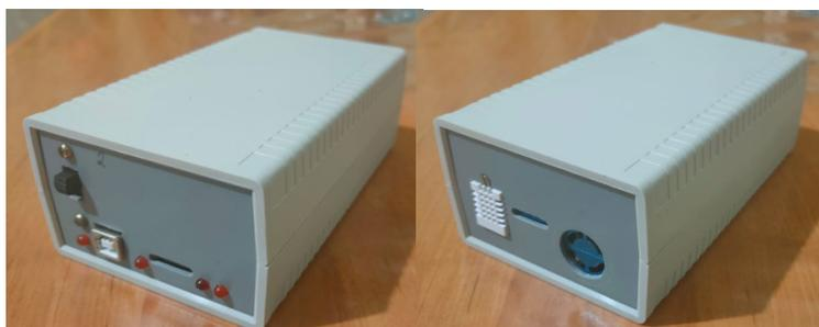
Рис. 2. Внешний вид пылемера ПИКМА-1
