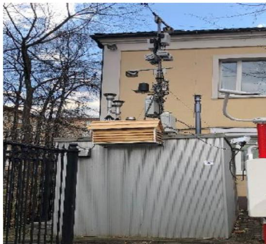
Рис. 3. Полевые исследования измерители концентрации пыли (сенсора пыли) AirExpert Mini PM
