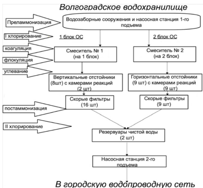
Рис. 1. Принципиальная технологическая схема «Северных» ВОС, Волгоград
