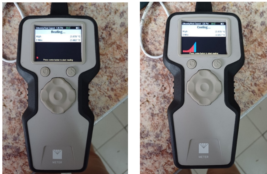
Рис. 1. Вид контроллера в ходе измерения теплофизических характеристик: а — нагрев щупов; б — остывание щупов
