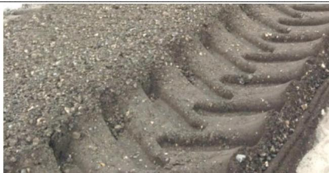
Рис. 6. Асфальто-щебеночно-грунтовая смесь после фрезерования дорожной одежды [1]
