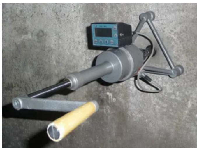
Рис. 3. Испытание на отрыв со скалыванием
