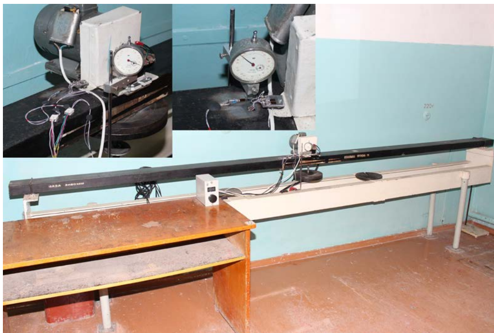
Рис. 5. Стенд для статических и динамических испытаний стальной прокатной балки с индикатором часового типа и элементами тензомостов ТА и ТР2
