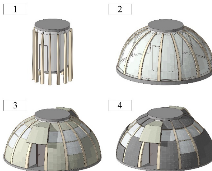
Рис. 7. Этапы разворачивания жилища для ситуаций быстрого реагирования первого типа (авторская разработка): 1 — основные конструкции жилого модуля в сложенном состоянии; 2 — первоначальный этап разворачивания, укрытие из гибкого стекла — поливинилхлорида; 3 — стандартный полноценный вид жилого модуля; 4 — вариация жилого дома с дополнительной утепляющей оболочкой для более холодного климата
