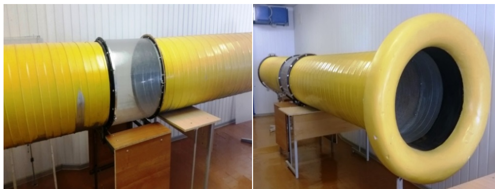
Рис. 2. Общий вид экспериментальной установки по исследованию закономерностей распространения пыли в потоке воздуха
