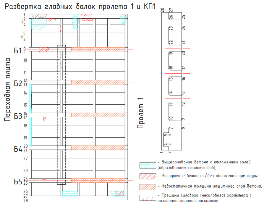
Рис. 4. Дефектовка (развертка) пролетного строения с указанием точек проведения испытаний
