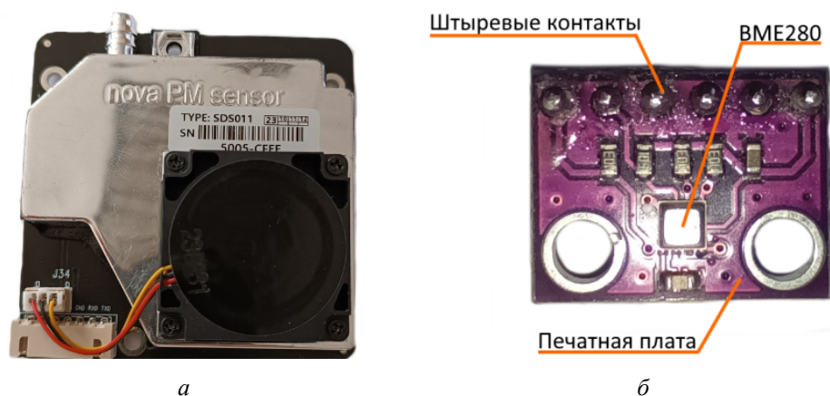
Рис. 2. Общий вид датчиков: a — датчик частиц Nova SDS011; b — датчик Bosch BME 280 (3.3 V)
