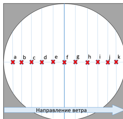
Рис. 4. Схема 2 — устье вентиляторной градирни (вид сверху); a, b, c ... k — точки проведения измерений
