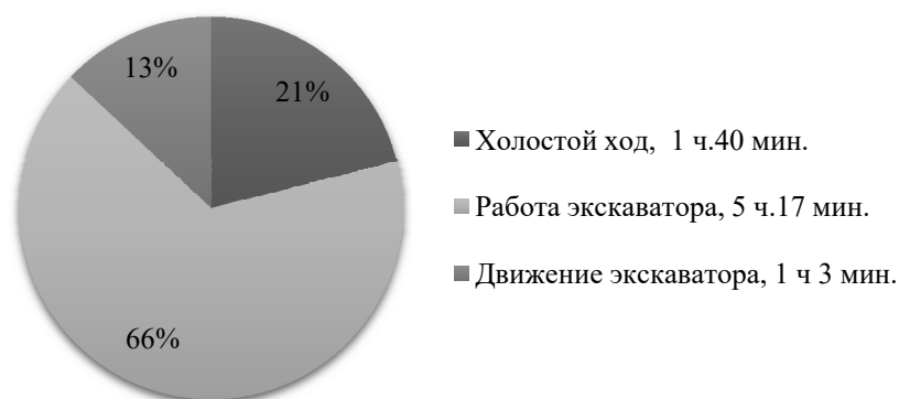
Рис. 1. Диаграмма распределения времени работы одноковшового экскаватора в течение рабочей смены [3]
