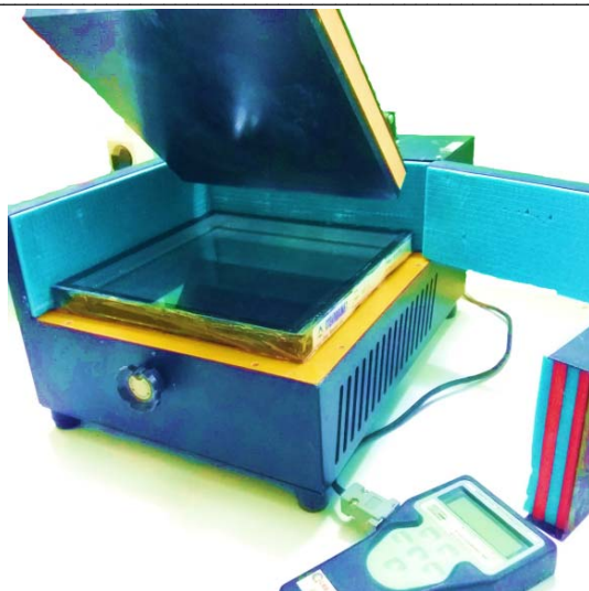
Конфигурация экспериментального стенда с интегрированным в него образцом однокамерного стеклопакета
