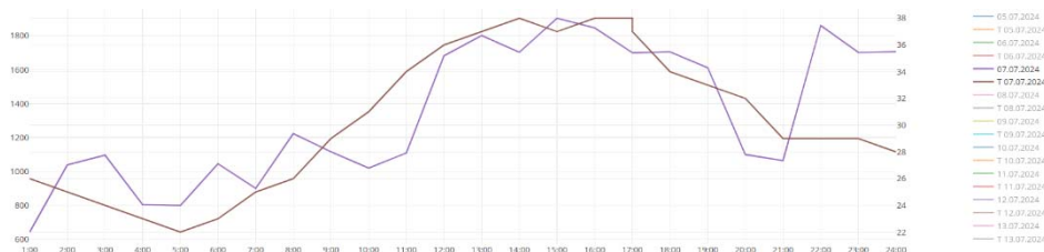
Рис. 8. Изменение суммарной фактической мощности Волжской ГЭС (фиолетовая линия, шкала слева) и температуры окружающего воздуха (коричневая линия, шкала справа) за сутки 07.07.2024
